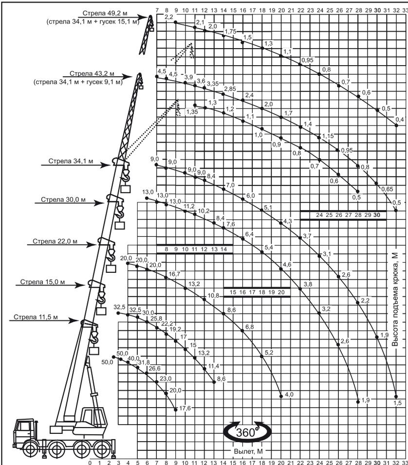
Кран КС-64713-2 грузоподъемностью 50т смонтирован на четырехосном шасси автомобиля МЗКТ-700600 с колесной формулой 8 x 4 x 4. Автокран предназначен для выполнения погрузочно-разгрузочных работ и строительно-монтажных работ на рассредоточенных объектах и может использоваться как в современных городах, так и в условиях удаленности от населенных пунктов.
